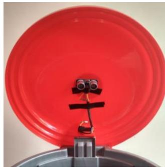
Gambar 9. Letak Sensor Ultrasonic
